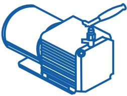
4.- Realizar un perfecto vacío (triple) a todo el sistema, incluyendo el compresor.
